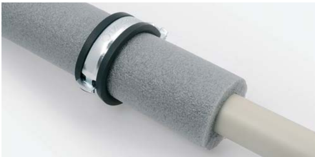
Для транспортування гарячої води хомут кріпиться через ізоляцію – на розмір більше
